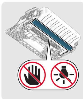
**6** Setzen Sie die neue Belichtungseinheit ein.
