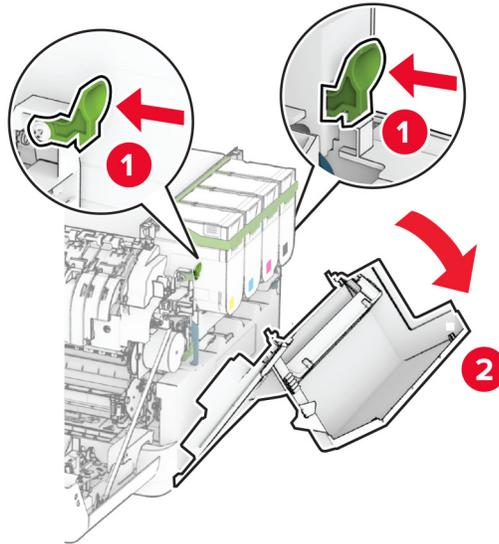
**4** Entfernen Sie Klappe B von der gebrauchten rechten Abdeckung.
