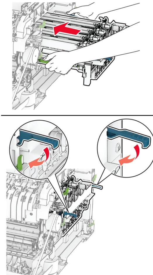
**11** Setzen Sie die Tonerkassetten so ein, dass sie *hörbar* einrasten.
