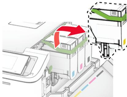
**6** Entfernen Sie die gebrauchte Imaging-Einheit.
