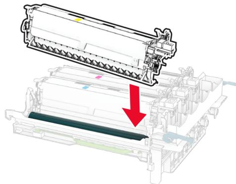
**10** Setzen Sie die Imaging-Einheit ein, bis diese fest einrastet.
