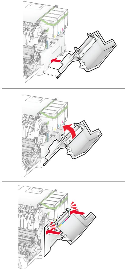
8 Schließen Sie Klappe A und anschließend Klappe B.
