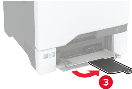
2 Passen Sie die Papierführung so an, dass sie dem Format des eingelegten Papiers entspricht.
