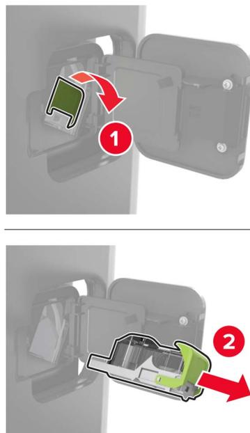
**3** Entfernen Sie die losen Heftklammern.
