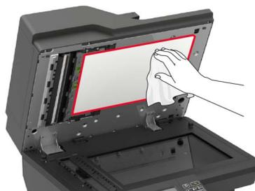
**3** Klappe E öffnen.
